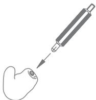
Entnehmen Sie das Wechselwerkzeug aus dem Filterspender und schieben Sie es in den Filter.
