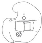
Anschließend setzen Sie die Batterie in das Batteriefach ein. Achten Sie dabei darauf, dass die Markierung (+) an der Batterie mit der Markierung (+) auf dem Batteriefach übereinstimmt.
