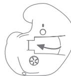
Öffnen Sie das Batteriefach vorsichtig mit dem Fingernagel an der dafür vorgesehenen Kante und schwenken es vollständig heraus.
