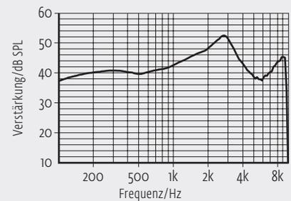
Die Kurven wurden mit einem 2cm<sup>3</sup>-Kuppler (EN 60318-5:2006) gemäß EN 60118-7:2005 in Messeinstellung ermittelt.
