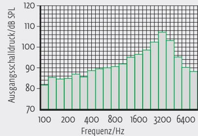
\* Alle Kurven wurden mit einem Ohrsimulator (EN 60318-4:2010) ermittelt. Das Rauschen wird nur bei in audifit aktiviertem Tinnitus-Modul erzeugt.
