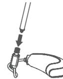
Utilice la herramienta de cambio para empujar el nuevo filtro hacia el orificio del filtro del receptor hasta que encaje. A continuación, extraiga simplemente la herramienta de cambio y guárdela.
