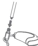
Gire la herramienta de cambio. En el otro extremo de la herramienta de cambio hay un nuevo filtro.
