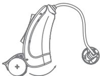
☞ No abra el compartimento de la pila más allá de lo indicado en la ilustración, pues esto puede provocar daños en el audífono.
