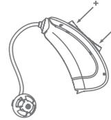
El interruptor basculante permite cambiar entre los programas auditivos. A tal fin, mantenga pulsado un extremo del interruptor basculante hasta que el cambio de programa se muestre de forma acústica. El número de tonos indica el número del programa seleccionado. Puede conmutar entre las situaciones de audición hacia delante o hacia atrás.
