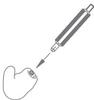
Extraiga la herramienta de cambio del dispensador de filtros y desplácela hacia el filtro.
