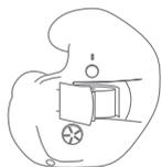
A continuación, coloque la pila en su compartimento, asegurándose al hacerlo de que la marca (+) de la pila coincida con la marca (+) del compartimento.
