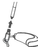
Extraiga la herramienta de cambio del dispensador de filtros y desplácela hacia el filtro.
