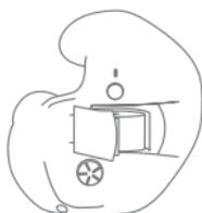
A continuación, coloque la batería en su compartimento, asegurándose al hacerlo de que la marca (+) de la batería coincida con la marca (+) del compartimento.
