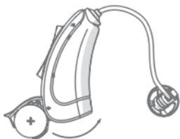
A continuación, coloque la batería en su compartimento, asegurándose al hacerlo de que la marca (+) de la batería coincida con la marca (+) del compartimento.
