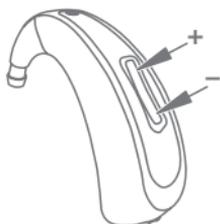
Sus audífonos disponen de un interruptor basculante multifunción que sirve para la regulación del volumen y la selección de los diversos programas. El interruptor basculante puede pulsarse y activarse en los lados superior (+) e inferior (-).
