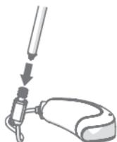
Utilice la herramienta de cambio para empujar el nuevo filtro hacia el orificio del filtro del audífono hasta que encaje. A continuación, extraiga la herramienta de cambio y deséchela.
