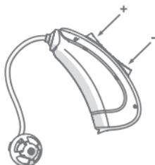
El volumen puede modificarse gradualmente con ayuda del interruptor basculante. Si se pulsa brevemente el extremo superior, el volumen aumenta, mientras que si se pulsa brevemente el extremo inferior, el volumen se reduce.
